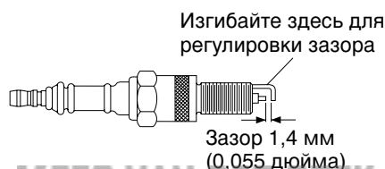
Рис. 12. Регулировка зазора свечи зажигания, нагреватель мощностью 10 кВт
