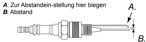
Abbildung 15 – Elektrodenabstand 20, 29, 44 kW Modelle.
