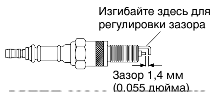
Рис. 12. Регулировка зазора свечи зажигания, нагреватель мощностью 10 кВт
