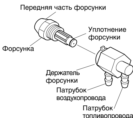
Рис. 22. Форсунка и держатель форсунки, нагреватель мощностью 10 кВт
