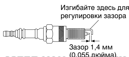
Рис. 12. Регулировка зазора свечи зажигания, нагреватель мощностью 10 кВт
